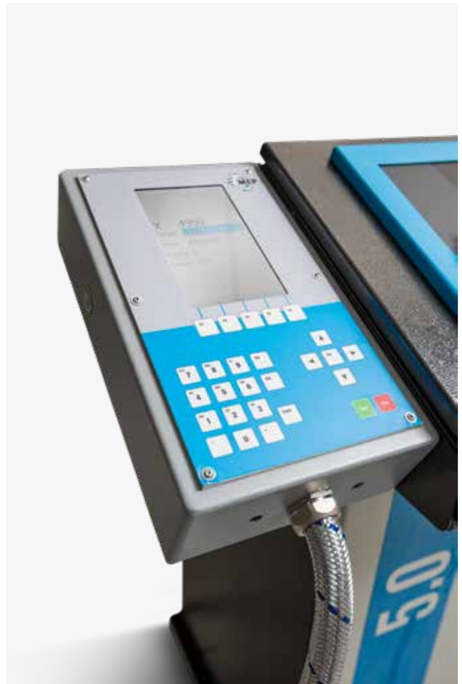
Steuerung mit 7"-Display, das seitlich am Schaltpaneel der Sägemaschine angebracht ist, komplette Steuerung mit Zählfunktion.
