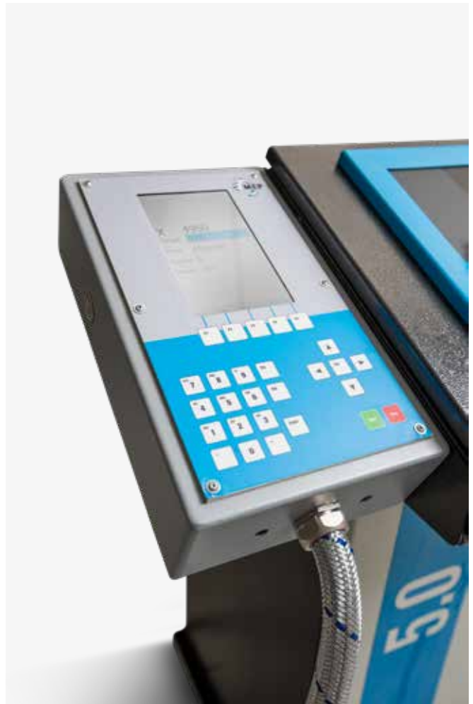
Control con pantalla de 7" montado al lado del control de la sierra y completo de función cuentapiezas.
