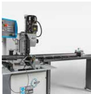
Posicionamiento manual del tope sin necesidad de conexión eléctrica porque funciona con baterías C de 1.5V.
