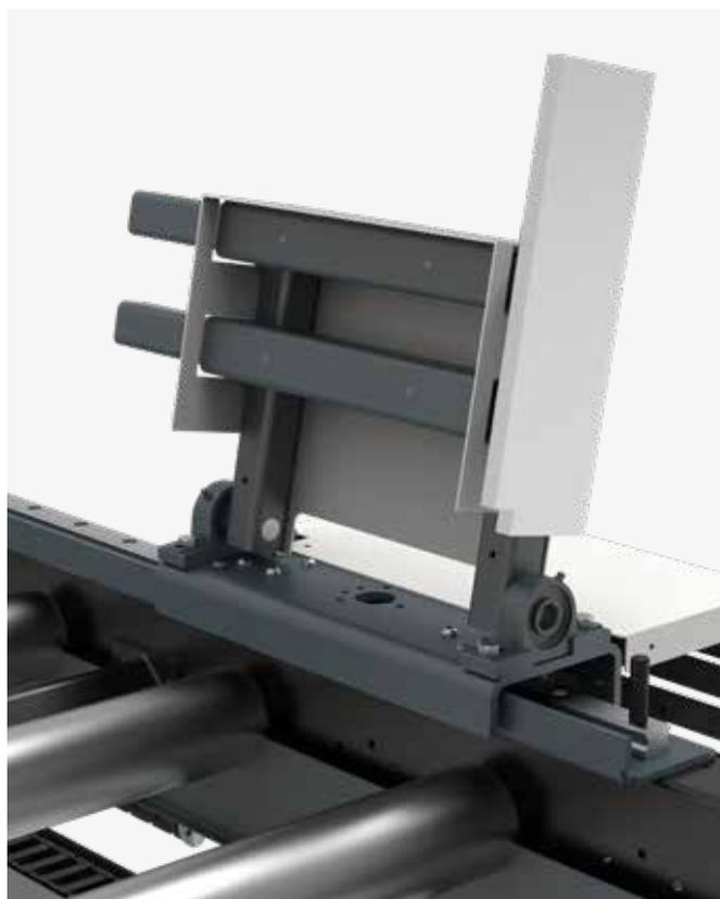
Sistema de medición motorizado y basculante manualmente montado en una guía lineal de 30 mm y servomotor de 3,3 Nm.
