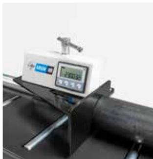
El montaje del tope se puede realizar tanto en carga como en descarga.
