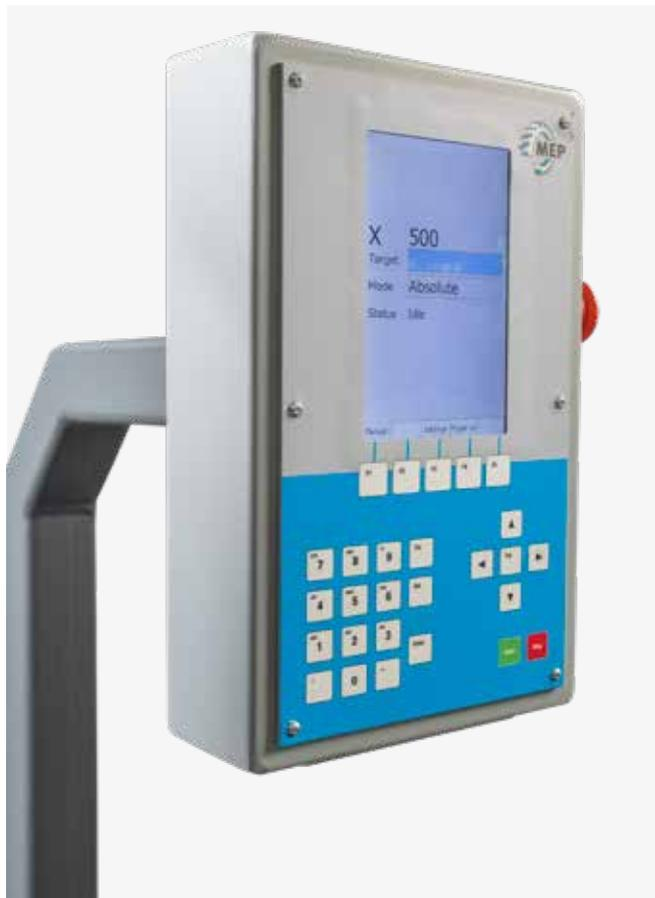
Control con pantalla de 7" montado al lado del control de la sierra y completo de función cuentapiezas, compensación del espesor de la hoja y dispositivo para la programación de forma remota a través de un cable ethernet.
