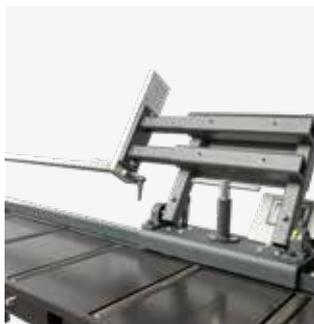
Tope basculante manual que se desliza sobre guía lineal de 30 mm.
