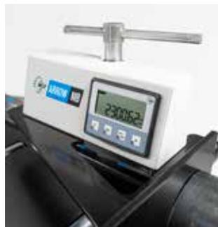
Visualización de la medida en pantalla. Palanca de bloqueo del tope en la medida deseada.
