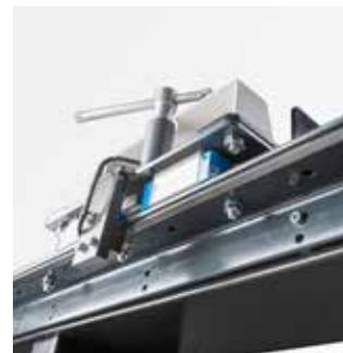
Detección de la longitud mediante banda magnética.
