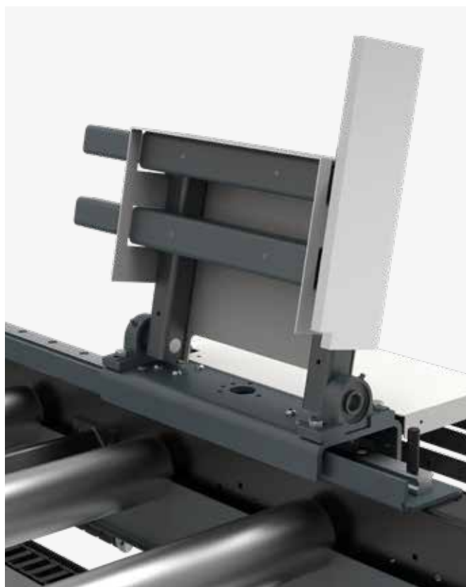
Système de mesure motorisée et rabattable manuellement monté sur un rail linéaire de 30 mm et servomoteur de 3,3 Nm
