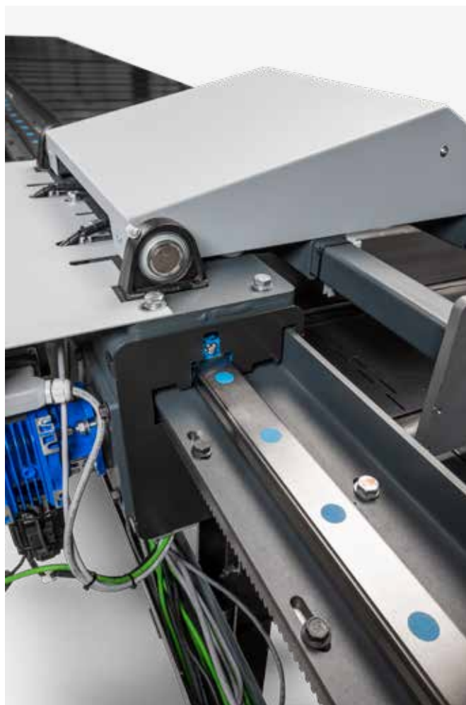
Batente motorizado montado num carril linear de 45mm e servomotor de 4,7Nm.
