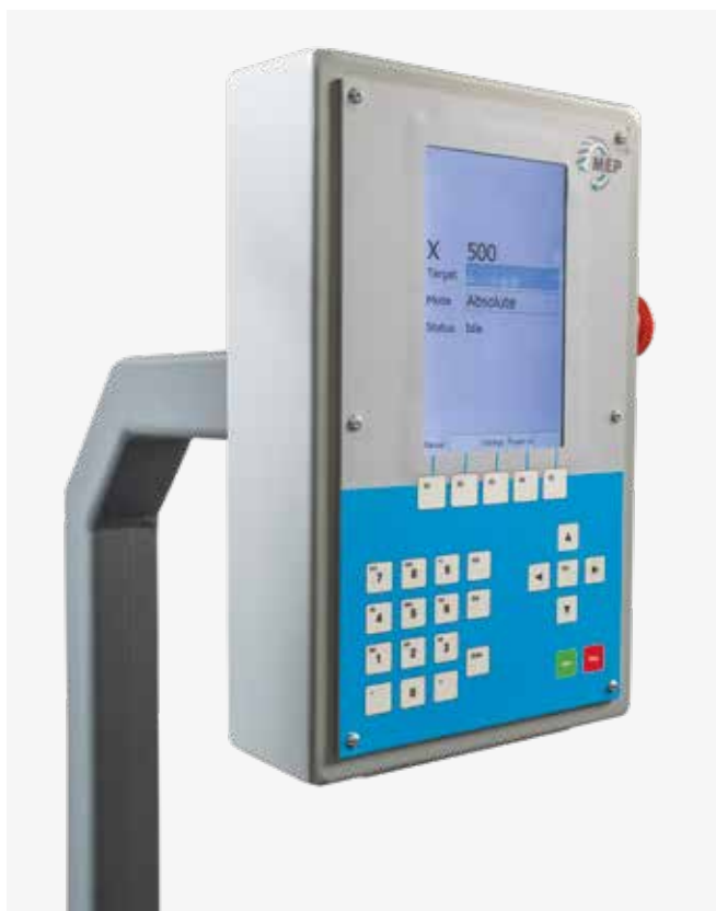
Schwenkbares Schaltpaneel mit 7"-Display auf selbsttragendem Fuß montiert: komplette Steuerung mit Zählerfunktion, Sägeblattstärkenkompensation und Vorrichtung zur Fernprogrammierung über Ethernet-Kabel.
