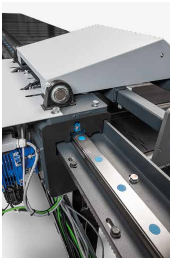
Motorisierter Anschlag auf einer linearen 45-mm-Führung und Servomotor 4,7 Nm.
