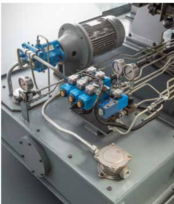
Centralita hidráulica de última generación de alta eficiencia y bajo consumo energético. La centralita hidráulica y el depósito son dos piezas para facilitar su mantenimiento.
