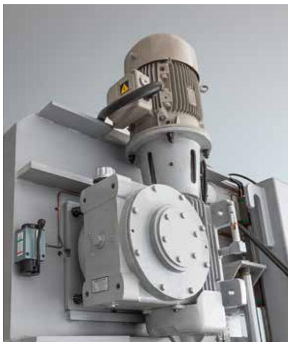
El motor de la hoja se acopla al reductor. La velocidad de rotación de la hoja se configura en la consola de la máquina mediante un inverter.
