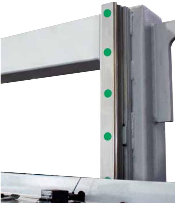
Avance del cabezal de corte en guías lineales con patines precargados de recirculación de bolas para garantizar una reducción de las vibraciones mecánicas durante el corte y una mayor estabilidad de corte.
