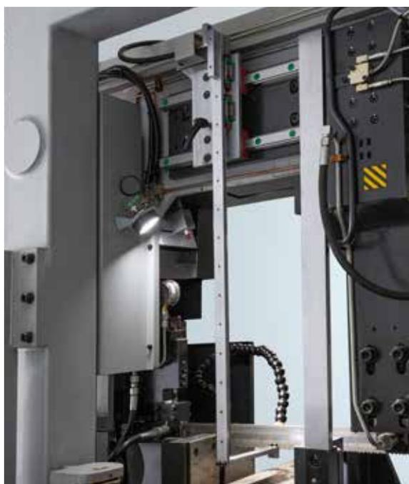
El dispositivo de aproximación rápida permite un descenso rápido del cabezal hasta una distancia cercana al material, reduciendo así el desgaste de la hoja y el tiempo de ciclo independientemente de las dimensiones del material de cortar.
