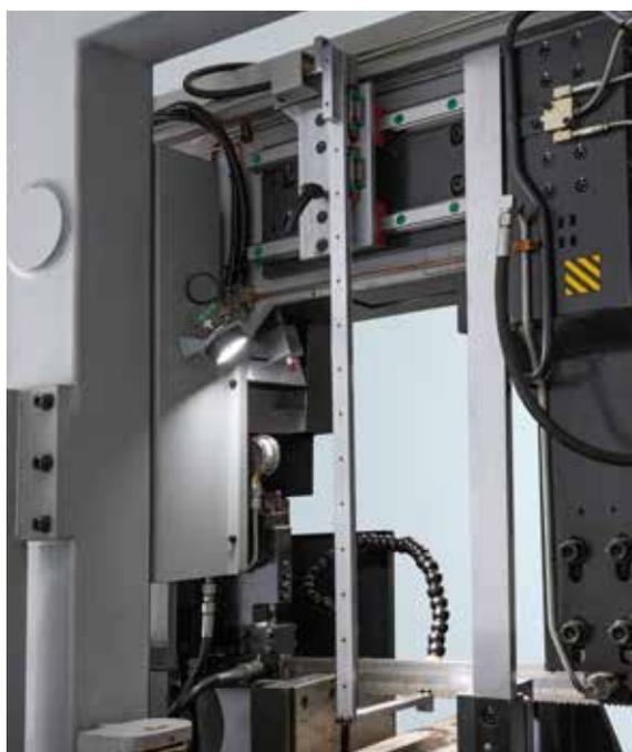
Il dispositivo di accostamento rapido permette una discesa veloce della testa fino ad una distanza ravvicinata al materiale, riducendo così l'usura della lama e il tempo ciclo indipendentemente dalla dimensione del materiale da tagliare.
