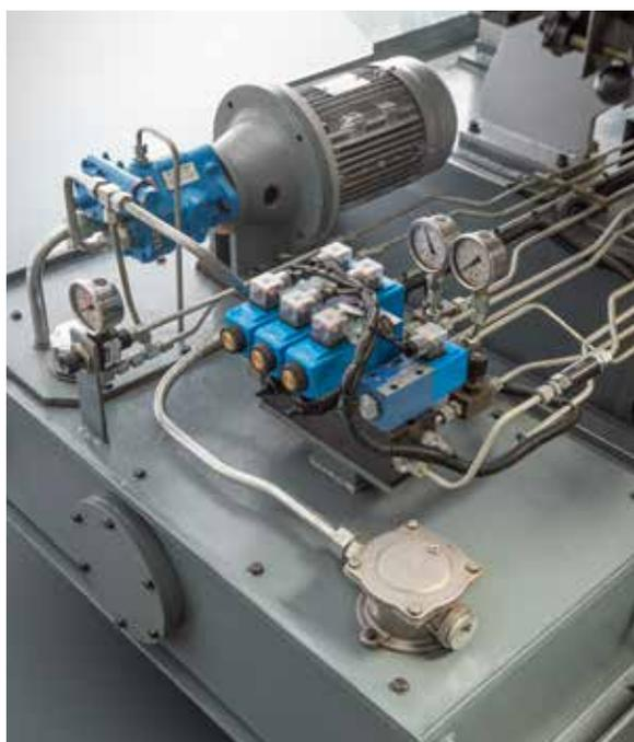
Centralina idraulica di ultima generazione ad elevata efficienza e basso consumo energetico. Centralina idraulica e serbatoio sono in due pezzi per facilitarne la manutenzione.
