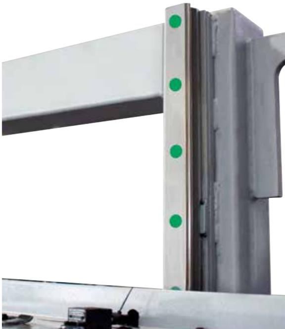
Avanzamento testa di taglio su guide lineari con pattini precaricati a ricircolo di sfere che garantisce una riduzione delle vibrazioni meccaniche durante il taglio e una maggiore stabilità di taglio.
