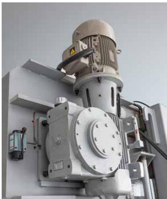
Il motore lama viene accoppiato al riduttore. La velocità di rotazione della lama viene impostata dalla console della macchina attraverso un inverter.
