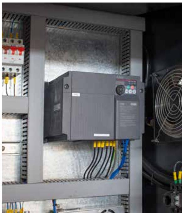
L'inverter per la regolazione continua della velocità consente di regolare la rotazione della lama in base al tipo di materiale.
