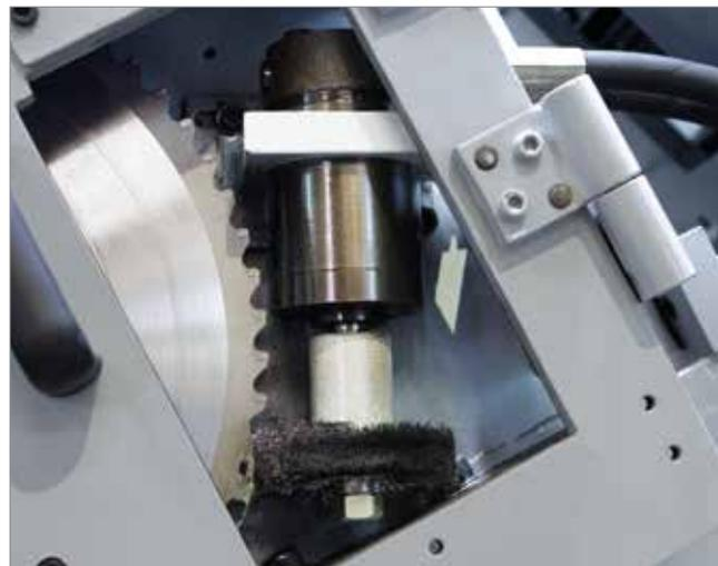
\_ Lubrificação automática de todas as partes móveis para garantir o funcionamento correto delas. A lubrificação pode ser temporizada por intermédio do controlador da máquina.
