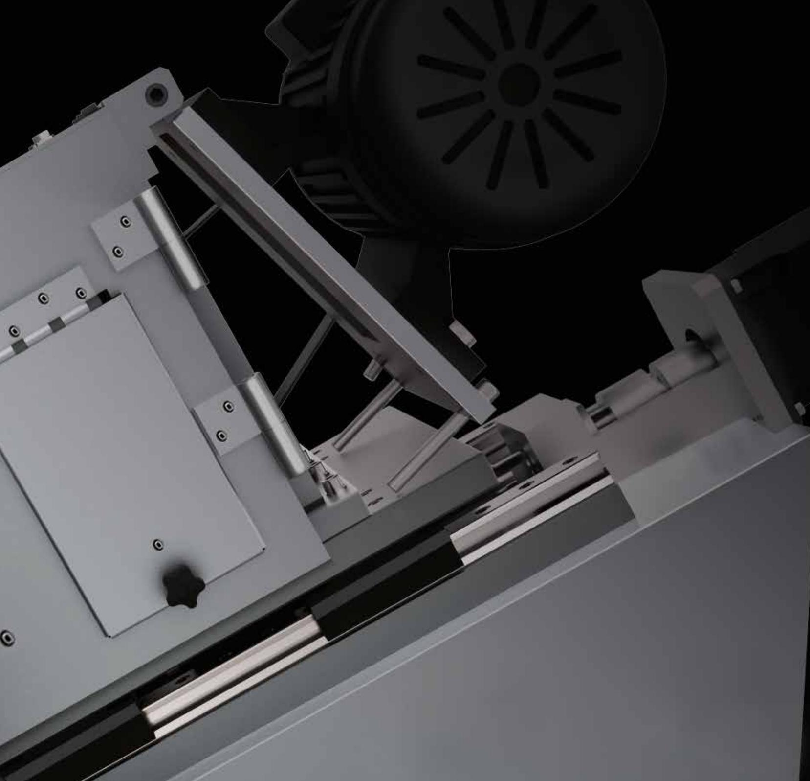
O motor elétrico é montado com o redutor e ambos são ligados mediante correias e polias. O conjunto é deslizante sobre guias lineares inclinadas para otimizar a entrada do disco no material e eliminar as vibrações, melhorando assim a vida útil da ferramenta.
