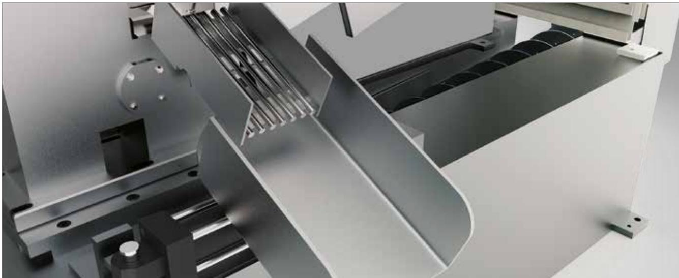
\_ Recuo automático do alimentador no final de cada corte para evitar o atrito com o material.
